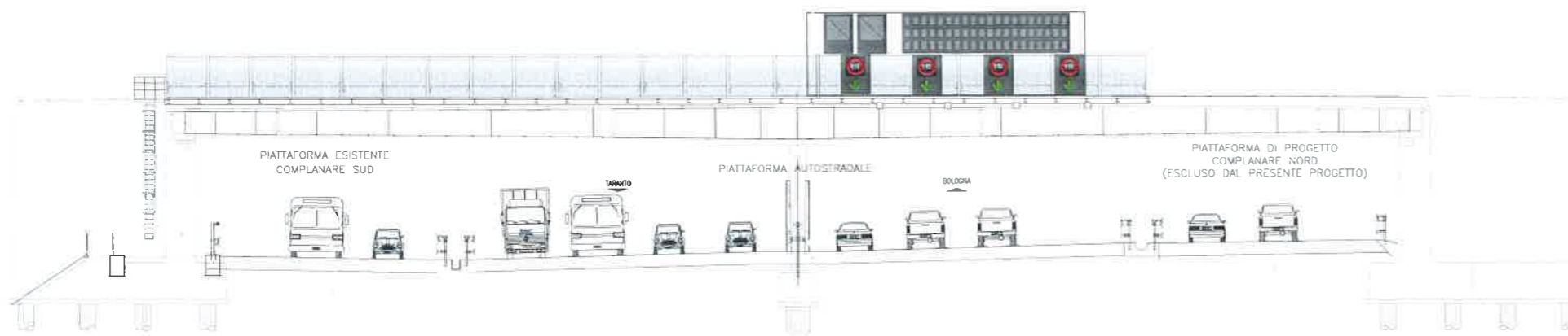
PMV SU CAVALCAVIA CON SEGNALETICA LUMINOSA "FRECCIA/CROCE" IN CONFIGURAZIONE QUARTA CORSIA DINAMICA APERTA
