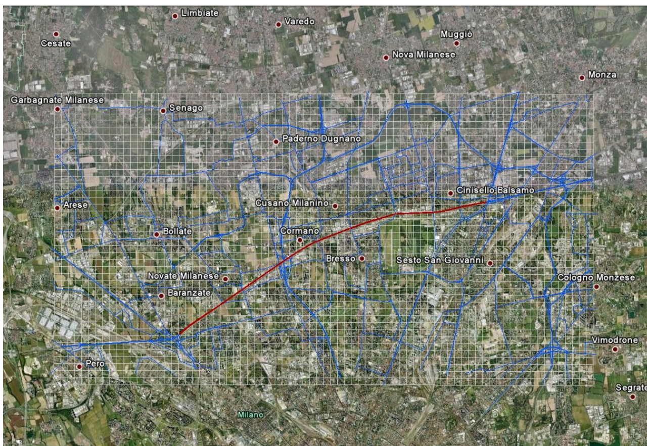
Figura 5. Dominio di calcolo del modello di simulazione. In blu la rete stradale modellata, in rosso l'asse della A4 oggetto del potenziamento viabilistico
